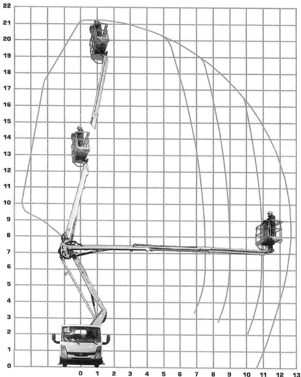
La Snake 2112 SMART è capace di un'altezza massima di lavoro di ben 21 m e di uno sbraccio laterale pari a 12 m.
